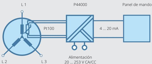
Los transmisores de la serie P44000 miden con precisión la temperatura de los RTD Pt100 en entornos de alta tensión, hasta 11 kV. El P44000 transforma la señal RTD a una salida estándar de 4 ... 20 mA que puede ser leída fácilmente por la mayoría de los sistemas de control.
