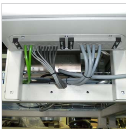
KEL-DPZ 24|x - Página 62 - 63 / FP|AE 330 - Página 149 Entrada de cables en cajas a través de placas de montaje. Se evitan mecanizados en chapa.
