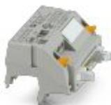
Adaptador V8 para 8 x PLC-INTERFACE (6,2 mm), control: Sistema de cableado PLC de tarjetas de salida, conexión 1: Conexión por tornillo 1x, conexión 2: Conector macho IDC/FLK 1x 14-polos, conexión 3: Conexión enchufable (Encajable en 8x bornes PLC-INTERFACE), número de canales: 8, lógica de mando: conexión a positivo
