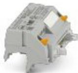
Adaptador V8 para 8 x PLC-INTERFACE (6,2 mm), control: Sistema de cableado PLC de tarjetas de salida, conexión 1: Conexión por tornillo 1x, conexión 2: Conector macho IDC/FLK 1x 14-polos, conexión 3: Conexión enchufable (Encajable en 8x bornes PLC-INTERFACE), número de canales: 8, lógica de mando: conexión a negativo
