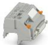
Adaptador V8 para 8 x PLC-INTERFACE (6,2 mm), control: Sistema de cableado PLC de tarjetas de salida, conexión 1: Conexión por tornillo 1x, conexión 2: Hembra de conexión D-SUB 1x 15-polos, conexión 3: Conexión enchufable (Encajable en 8x bornes PLC-INTERFACE), número de canales: 8, lógica de mando: conexión a positivo
