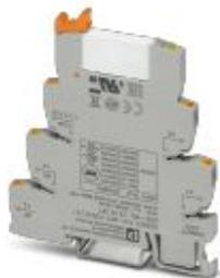
PLC-INTERFACE, consta de un borne de base PLC-BPT.../21 con conexión Push-in y relé miniatura enchufable con contacto de potencia, para montaje sobre carril simétrico NS 35/7,5, 1 contacto inverso, tensión de entrada 230 V AC/220 V DC
