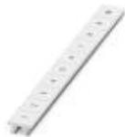
Tira Zack, Tiras, blanco, rotulado, rotulable con: CMS-P1-PLOTTER, rotulación longitudinal: números correlativos de 1 ...10, 11 ...20 etc. hasta 991 ...1000, clase de montaje: encajar en ranura para índice alta, para ancho de borne: 10,2 mm, superficie útil: 10,15 x 10,5 mm, Número de índices individuales: 10
