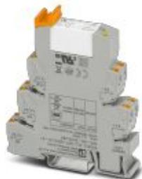
PLC-INTERFACE, consta de un borne de base PLC-BPT.../21-21 con conexión push-in y relé miniatura enchufable con contacto de potencia, para montaje sobre carril simétrico NS 35/7,5, 2 contactos inversores, tensión de entrada 60 V DC
