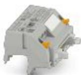
Adaptador V8 para 8 x PLC-INTERFACE (6,2 mm), control: Sistema de cableado PLC de tarjetas de entrada, conexión 1: Conexión por tornillo 1x, conexión 2: Conector macho IDC/FLK 1x 14-polos, conexión 3: Conexión enchufable (Encajable en 8x bornes PLC-INTERFACE), número de canales: 8, lógica de mando: conexión a negativo
