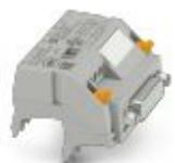
Adaptador V8 para 8 x PLC-INTERFACE (6,2 mm), control: Sistema de cableado PLC de tarjetas de entrada, conexión 1: Conexión por tornillo 1x, conexión 2: Hembra de conexión D-SUB 1x 15-polos, conexión 3: Conexión enchufable (Encajable en 8x bornes PLC-INTERFACE), número de canales: 8, lógica de mando: conexión a positivo
