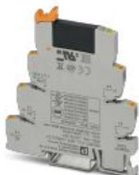
PLC-INTERFACE, compuesto de borne de base PLC-BPT.../21 con conexión push-in y relé de estado sólido en miniatura enchufable, para el montaje sobre carril NS 35/7,5, 1 contacto de cierre, entrada: 230 V AC/220 V DC, salida: 3-48 V DC/100 mA
