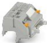
Adaptador V8 para 8 x PLC-INTERFACE (6,2 mm), control: Sistema de cableado PLC de tarjetas de entrada, conexión 1: Conexión por tornillo 1x, conexión 2: Conector macho IDC/FLK 1x 14-polos, conexión 3: Conexión enchufable (Encajable en 8x bornes PLC-INTERFACE), número de canales: 8, lógica de mando: conexión a positivo
