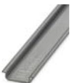
Carril simétrico sin perforar, Perfil estándar, anchura: 35 mm, altura: 7,5 mm, según EN 60715, material: Acero inoxidable V2A, sin recubrimiento, longitud: 2000 mm, color: plateado
