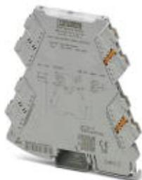
Separador de 2 vías alimentado en bucle de entrada de un canal con tecnología de conexión enchufable para la separación galvánica de señales analógicas. Señal de entrada = señal de salida: 0(4)mA ... 20 mA. Tecnología de conexión push-in.
