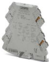
Amplificador separador de alimentación de 3 vías con técnica de conexión enchufable. Transparencia HART, señal de entrada 0(4)...20 mA, señal de salida 0(4)...20 mA. El dispositivo puede usarse tanto en modo de separador como en modo de amplificador separador de alimentación. Técnica de conexión push-in
