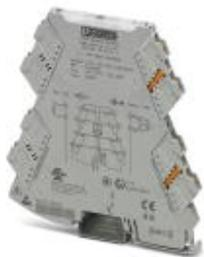
Amplificador de separación de 3 vías con técnica de conexión enchufable para la separación galvánica de señales analógicas unipolares y bipolares. Señal de entrada: 0 ... 10 V/±10 V, señal de salida: 0 ... 10 V/±10 V, técnica de conexión push-in.
