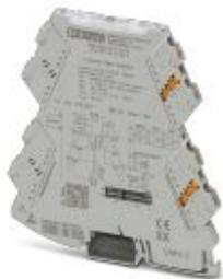
Convertidor de frecuencia configurable de forma universal para la conversión de señales de frecuencia y PWM en señales normalizadas. Posibilidad de tensiones de sensores superiores a 8,2 V DC, en combinación con MINI MCR-2-SPS-PT 1033201. Tecnología de conexión push-in.
