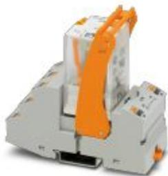
Módulo de relé premontado con conexión push-in, compuesto de: zócalo de relé, relé con contacto de potencia, módulo de indicación/antiparasitario enchufable y brida de sujeción. Tipo de contacto: 3 contactos inversores. Tensión de entrada: 120 V AC
