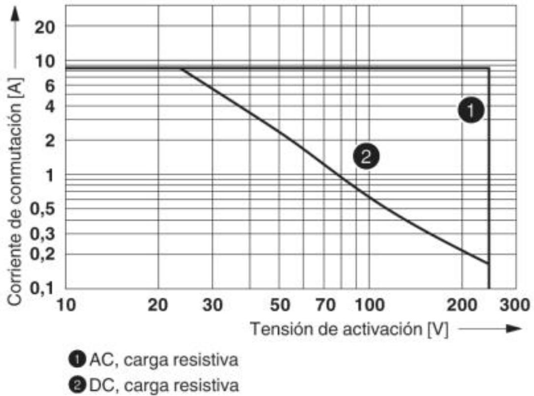
Potencia de ruptura
