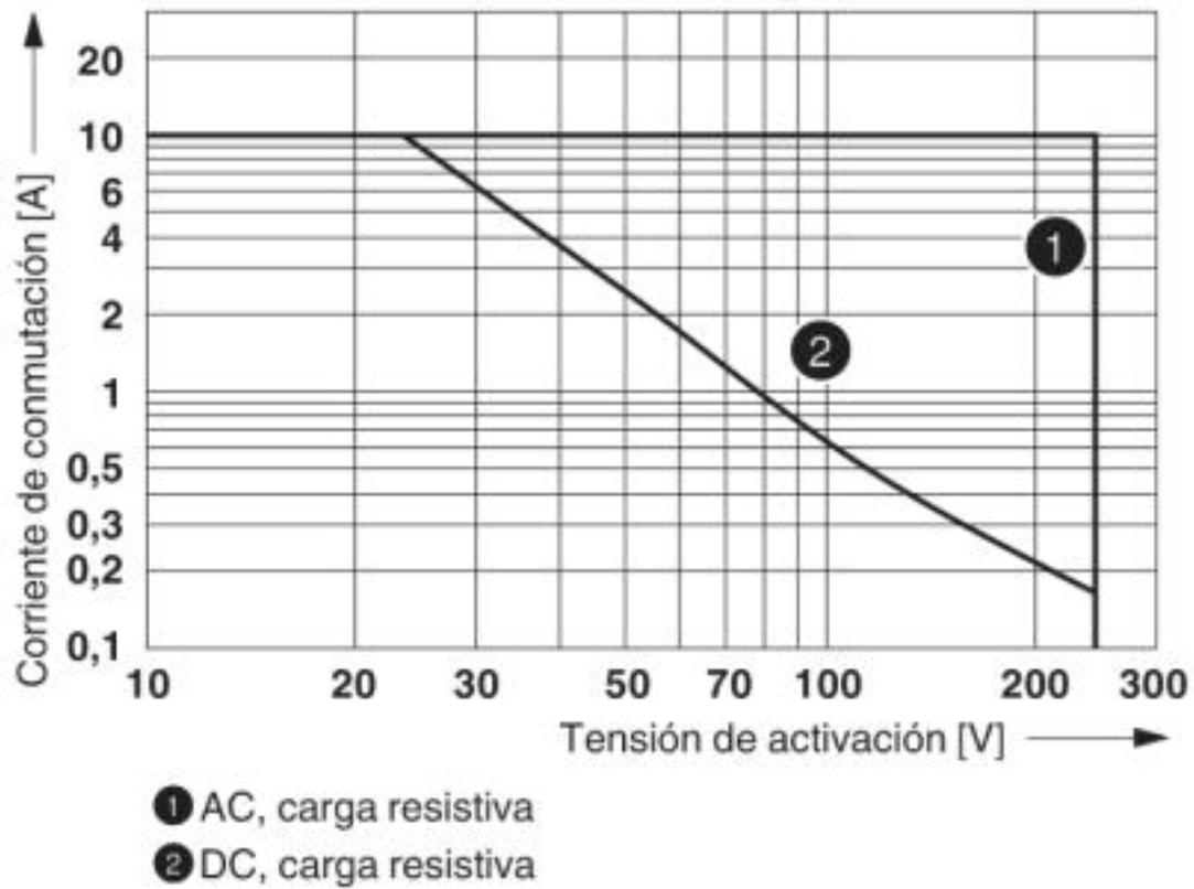
Potencia de ruptura
