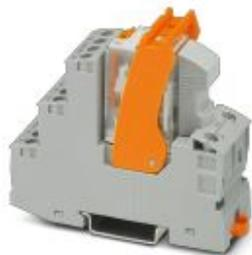
Módulo de relé premontado con conexión por tornillo, compuesto de: zócalo de relé, relé con contacto de potencia, módulo de indicación/antiparasitario enchufable y brida de sujeción. Tipo de contacto: 4 contactos conmutados. Tensión de entrada: 120 V AC
