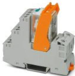
Módulo de relé premontado con conexión por tornillo, compuesto de: zócalo de relé, relé con contacto de potencia y brida de sujeción. Tipo de contacto: 4 contactos conmutados. Tensión de entrada: 125 V DC
