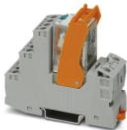
Módulo de relé premontado con conexión por tornillo, compuesto de: zócalo de relé, relé con contacto de potencia y brida de sujeción. Tipo de contacto: 4 contactos conmutados. Tensión de entrada: 24 V DC
