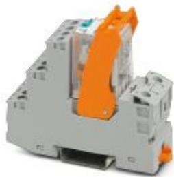
Módulo de relé premontado con conexión por tornillo, compuesto de: zócalo de relé, relé con contacto de potencia y brida de sujeción. Tipo de contacto: 2 contactos conmutados. Tensión de entrada: 125 V DC
