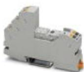
Zócalo de relé RIF-1..., para relés miniatura de potencia con 1 o 2 contactos inversores o relés de estado sólido de construcción idéntica, conexión "push-in", posibilidad de enchufe para módulos de entrada/antiparasitarios, para el montaje sobre NS 35/7,5
