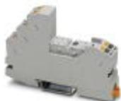
Zócalo de relé RIF-1..., para relés miniatura de potencia con 1 o 2 contactos inversores o relés de estado sólido de construcción idéntica, conexión "push-in", posibilidad de enchufe para módulos de entrada/antiparasitarios, para el montaje sobre NS 35/7,5
