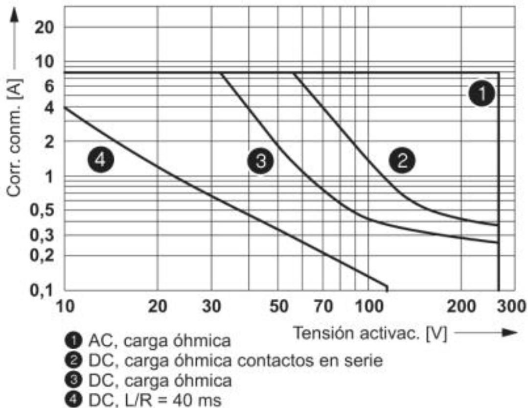
Potencia de ruptura
