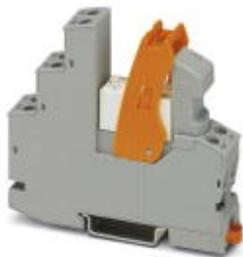
Módulo de relé premontado con conexión por tornillo, compuesto de: zócalo de relé, relé con contacto de potencia, módulo de indicación/antiparasitario enchufable y brida de sujeción. Tipo de contacto: 1 contacto conmutado. Tensión de entrada: 230 V AC
