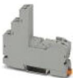
Zócalo de relé RIF-1..., para relés de potencia en miniatura con 1 o 2 contactos conmutados o relés de estado sólido de la misma construcción, conexión por tornillo, posibilidad de enchufe para módulos de entrada/antiparasitario, para montaje sobre carril NS 35/7,5
