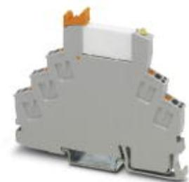
Módulo de relé premontado con conexión push-in, compuesto de: zócalo de relé con eyector y relé con contacto de potencia. Tipo de contacto: 1 contacto inversor. Tensión de entrada: 12 V DC
