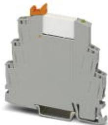
Módulo de relé premontado con conexión por tornillo, compuesto de: zócalo de relé con eyector y relé con contacto de potencia. Tipo de contacto: 1 contacto conmutado. Tensión de entrada: 12 V DC
