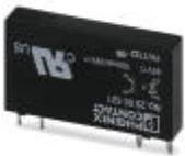
Relé de estado sólido en miniatura enchufable, relé de estado sólido de entrada, 1 contacto de cierre, entrada: 60 V DC, salida: 3-48 V DC/100 mA
