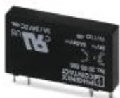
Relé de estado sólido en miniatura enchufable, relé de estado sólido de potencia, 1 contacto de cierre, entrada: 24 V DC, salida: 3 ... 33 V DC/3 A
