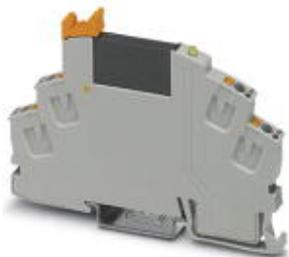
Módulo de relé de estado sólido premontado con conexión push-in, compuesto de: zócalo de relé con eyector y relé de estado sólido miniatura enchufable. Tensión de entrada: 24 V DC. Salida: 3-33 V DC/3 A
