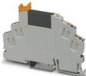
Módulo de relé de estado sólido premontado con conexión push-in, compuesto de: zócalo de relé con eyector y relé de estado sólido miniatura enchufable. Tensión de entrada: 24 V DC. Salida: 3-48 V DC/100 mA
