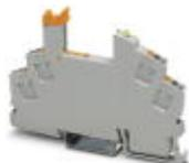
Zócalo de relé RIF-0..., para relés miniatura de potencia con 1 contacto abierto o relés de estado sólido de construcción idéntica, conexión "push-in", para el montaje sobre NS 35/7,5
