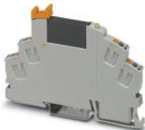
Módulo de relé de estado sólido premontado con conexión push-in, compuesto de: zócalo de relé con eyector y relé de estado sólido miniatura enchufable. Tensión de entrada: 24 V DC. Salida: 24-253 V AC/0,75 A
