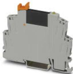
Módulo de relé de estado sólido premontado con conexión por tornillo, compuesto de: zócalo de relé con eyector y relé de estado sólido en miniatura enchufable. Tensión de entrada: 24 V DC. Salida: 24-253 V AC/0,75 A
