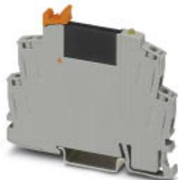
Módulo de relé de estado sólido premontado con conexión por tornillo, compuesto de: zócalo de relé con eyector y relé de estado sólido en miniatura enchufable. Tensión de entrada: 24 V DC. Salida: 3-48 V DC/100 mA
