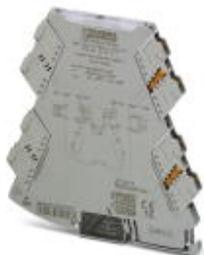
Separador monocanal de 2 vías alimentado por bucle de salida con técnica de conexión enchufable para la separación galvánica de señales analógicas. Señal de entrada = señal de salida: 0(4)mA ... 20 mA. Técnica de conexión push-in.
