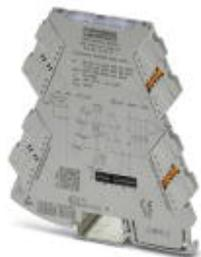
Interruptor de valor límite de temperatura de configuración universal con dos salidas de transistor para la conexión de termorresistencias y termopares de 2, 3 y 4 conductores. Configurable mediante el interruptor DIP o el software, tecnología de conexión push-in
