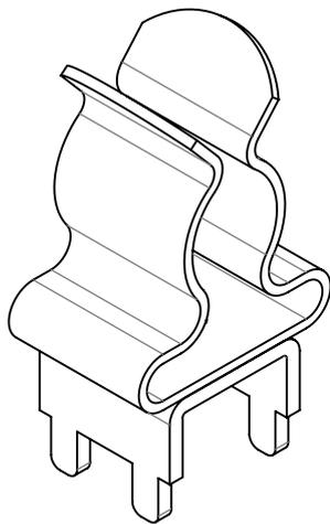
4x Bohrung LP = Ø 1,8 mm
