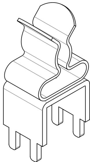
4x Bohrung LP = Ø 1,8 mm
