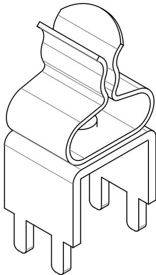
4x Bohrung LP = Ø 1,8 mm
