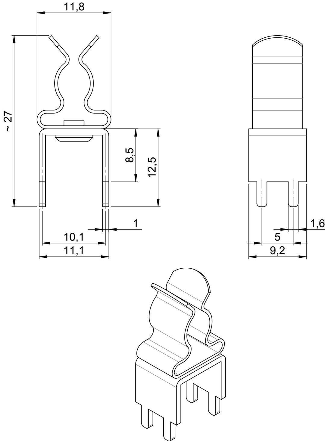
4x Bohrung LP = Ø 1,8 mm
