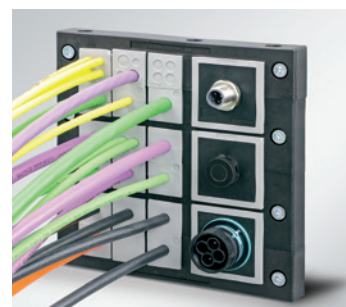
KEL 24/21-2 MT montado con 3x AT-M, equipado con un conector M16 circular, un compensador de presión M12 y un conector híbrido
