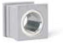
El AT-K-M es un inserto adaptador (basado en los insertos KT pequeños) que lleva integrada una rosca métrica, válida para los pasamuros partidos de icotek. Los materiales de los insertos adaptadores AT-M son elastómeros sobre un marco de latón niquelado. Los insertos adaptadores AT-K-M están disponibles con roscas internas de M5 x 0.5, M8 x 0.5, M8 x 1.0, M12 x 1.0, M12 x 1.5, M14 x 1.0 y M16 x 1.5, 1/8" y 1/4".
