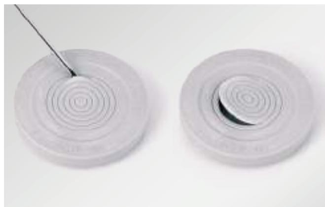
Los aros circulares individuales se van eliminando en función del diámetro del cable o tubo. Para ello sólo es necesario hacer un agujero en el contorno del aro a eliminar, el resto sale fácilmente.
