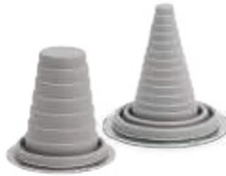
La serie KEL-ULTRA flex ha sido desarrollada para la entrada de gruesos cables en los armarios. Se dispone de un amplio rango de diámetros desde 25 hasta un máximo de 115 mm. Gracias a su diseño piramidal se permite la entrada y el posicionado del cable, simplificándolo frente a las soluciones basadas en prensaestopas.
