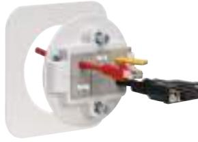
El KVT 80 es un sistema pasacables de marco partido que permite el paso de cables y mangueras conectorizadas aportando estanqueidad. Mediante el apriete de las dos partes del marco se genera la presión necesaria sobre los insertos. Gracias a los elementos de fijación en su parte trasera se puede montar en chapas de 1.5 hasta 10 mm para garantizar una fuerza de retención sobre el cable que lo haga resistente a la tracción.
