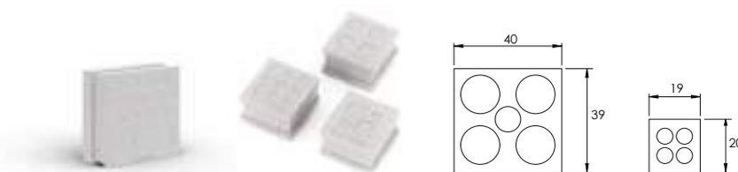
Los insertos con membranas QT-DT se pueden utilizar en cualquier sitio, donde se tengan que pasar y sellar con IP54, una gran cantidad de líneas eléctricas, neumáticas ó hidráulicas. Al utilizar los insertos QT-DT, la densidad de cableado se puede aumentar de forma significativa.
