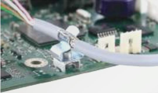
Los clips para pantalla SKL se emplean allí donde deba conectarse a potencial de tierra la pantalla de un cable. Estos clips permiten un montaje sencillo y seguro de las pantallas de los cables.
