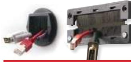
Los pasamuros partidos de escobillas KEL-BES-S se emplean para el paso de cables en armarios eléctricos (p. ej. telecomunicaciones). Los pasamuros de escobillas pueden montarse tanto con tornillos como con remaches. Gracias al marco partido, los KEL-BES-S pueden montarse una vez que los cables están ya pasados. Los recortes de panel son los mismos que los empleados en los conectores industriales estándar de 10, 16 y 24 polos.
