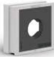
El inserto QT-AT-M, basado en los insertos QT grandes, incorpora roscas métricas y es integrable en los marcos pasamuros de icotek. Los insertos QT-AT-M están compuestos de elastómero sobre un cuerpo de poliamida. Los insertos QT-AT-M están disponibles con roscas internas de M12x1,0, M16x1,5, M20x1,5 y M25x1,5.
