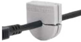
Con el pasacables partido UT, cables con y sin conectores se pueden insertar de forma fácil y rentable en una caja con un sellado hasta IP54. Todo lo que se requiere para su instalación es un corte en forma de U en el que se coloca el inserto. El UT se puede utilizar para cables (mangueras de aire comprimido, tubos de fibra de vidrio, etc.) con diámetros de 4 a 11 mm. El espesor de la pared de la carcasa puede ser de 1 a 4 mm.
