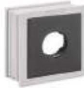
El inserto AT-M, basado en los insertos KT grandes, incorpora roscas métricas y es integrable en los marcos pasamuros de icotek. Los insertos AT-M están compuestos de elastómero sobre un cuerpo de poliamida. Los insertos AT-M están disponibles con roscas internas de M12x1.0, M16x1.5, M20x1.5 y M25x1.5.
