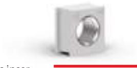
El QT-AT-K-M es un inserto adaptador (basado en los insertos QT pequeños) que lleva integrada una rosca métrica, válida para los pasamuros partidos de icotek. Los materiales de los insertos adaptadores QT-AT-M son elastómeros sobre un marco de latón niquelado. Los insertos adaptadores QT-AT-K-M están disponibles con roscas internas de M5 x 0.5, M8 x 0.5, M8 x 1.0, M12 x 1.0, M12 x 1.5.
