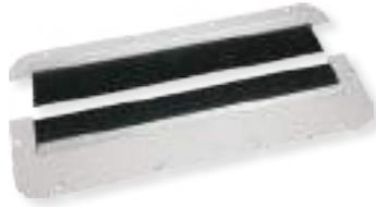
Las placas de montaje partidas viene equipadas cada una con una tira de escobillas para montarse de forma enfrentada. La altura de las escobillas es distinta (1x35mm y 1x50mm). Este sistema de paso de cables permite el paso de cables conectorizados manteniendo una protección contra polvo y suciedad. Estas placas están diseñadas para cajas Rittal de la serie AX.
