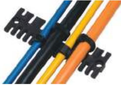
Los sistemas de fijación y guiado de cables ZL 03 | 04 | 05 disponen de distintos anchos en sus dientes. Esto permite el montaje de los más variados tipos de cables. La forma de los soportes asegura que, ni la brida ni el cable, se puedan deslizar accidentalmente garantizando un amarre seguro de los cables. Resistencia a la tracción según UNE-EN 62444. La resistencia a la tracción se garantiza con las bridas KB.
