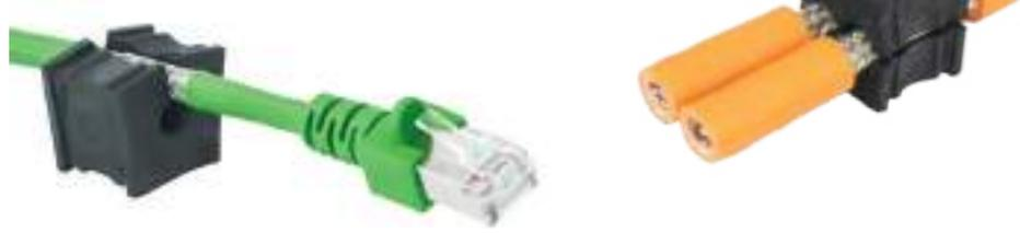
Los insertos para cables del tipo EMC-KT están fabricados con un elastómero muy conductivo. De esta forma, se eliminan las interferencias de la pantalla del cable directamente por medio del inserto, el marco y la junta plana.
