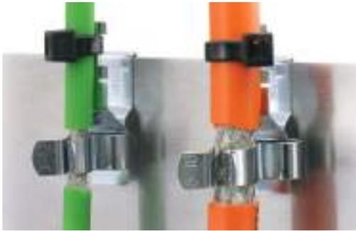
Los clips de pantalla se pueden emplear allí donde deba conectarse a potencial de tierra las pantallas de los cables. Los clips de pantallas son muy sencillos de montar y muy efectivos para derivar a tierra las perturbaciones recogidas en las mallas de los cables.
