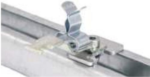
Los clips de pantalla se pueden emplear allí donde deba conectarse a potencial de tierra las pantallas de los cables. Los clips de pantallas son muy sencillos de montar y muy efectivos para derivar a tierra las perturbaciones recogidas en las mallas de los cables.
