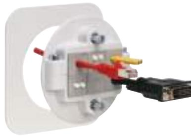
El KVT 80 es una sistema pasacables de marco partido que permite el paso de cables y mangueras conectorizadas aportando estanqueidad. Mediante el apriete de las dos partes del marco se genera la presión necesaria sobre los insertos. Gracias a los elementos de fijación en su parte trasera se puede montar en chapas de 1.5 hasta 10 mm para garantizar una fuerza de retención sobre el cable que lo haga resistente a la tracción.
