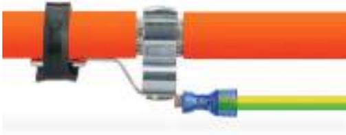
Los clips de pantalla se pueden emplear allí donde deba conectarse a potencial de tierra las pantallas de los cables. Los clips de pantallas son muy sencillos de montar y muy efectivos para derivar a tierra las perturbaciones recogidas en las mallas de los cables.
