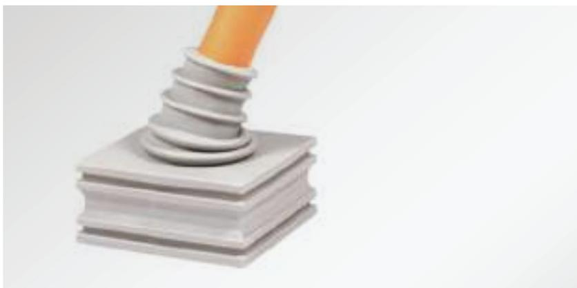
Los insertos mutirango KT-DPF permiten alojar un amplio rango de diámetros, lo que supone una gran ventaja cuando no se conoce el diámetro del cable previamente. Gracias a la flexibilidad que aporta su forma cónica se facilita el montaje de cables rígidos de forma notable en comparación con el montaje equivalente en un prensaestopas. Se recomienda emplear una brida para dotar al sistema de mayor resistencia antitracción.
