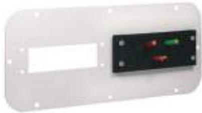
Placas de montaje FP con recortes 112 × 36 mm para armarios compactos de la serie AE, Sistema TopPult TP y Cajas con recortes para placas de montaje. Los recortes y taladros de fijación de las placas se ajustan a las dimensiones normalizadas de los conectores industriales de 24 polos.
