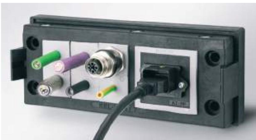
El inserto AT-PP está construido sobre la base de un inserto grande KT. Sobre el elastómero se ha integrado un cuerpo de poliamida. Todos los módulos basados en el sistema Push-Pull pueden ser encajados en el inserto.
