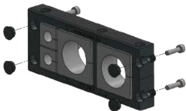
En caso de montaje trasero (atornillando desde el interior) usando marcos con tuercas embutidas, estos tienen una apertura en el frontal de los puntos de amarre. Esta apertura se puede cerrar con los **tapones A**. (Ref: 99142)
