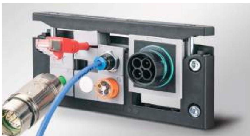
El AT-K-M es un inserto adaptador (basado en los insertos KT pequeños) que lleva integrada una rosca métrica, válida para los pasamuros partidos de icotek. Los materiales de los insertos adaptadores AT-M son elastómeros sobre un marco de latón niquelado. Los insertos adaptadores AT-K-M están disponibles con roscas internas de M5 x 0,5, M8 x 0,5, M8 x 1,0, M12 x 1,0, M12 x 1,5, M14 x 1,0 y M16 x 1,5, 1/8" y 1/4".
