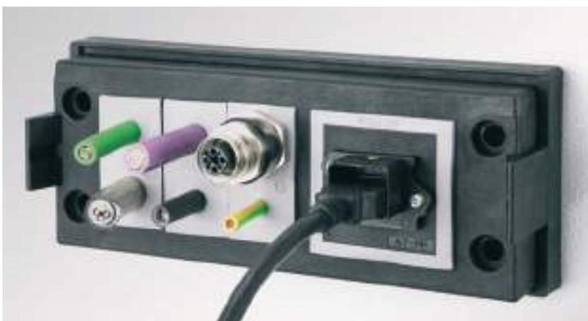
El inserto QT-AT-PP está construido sobre la base de un inserto grande QT. Sobre el elastómero se ha integrado un cuerpo de poliamida. Todos los módulos basados en el sistema Push-Pull pueden ser encajados en el inserto.
